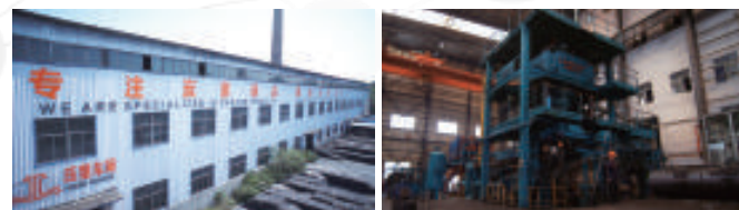
压型工序 41MN、25MN、15MN压机 Forming 41MN, 25MN and 15 MN Extrusion Press
